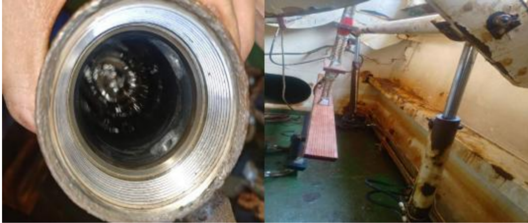
Port side pilot door close /open hyd cylinder overhauling :
