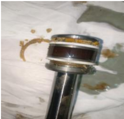
Port side pilot door close /open hyd cylinder overhauling :
